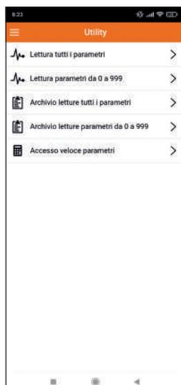
L'icona "Strumenti" apre la schermata a fianco, pensata per essere un utile strumento di diagnostica del gruppo valvole. Le funzioni incluse sono le seguenti.
